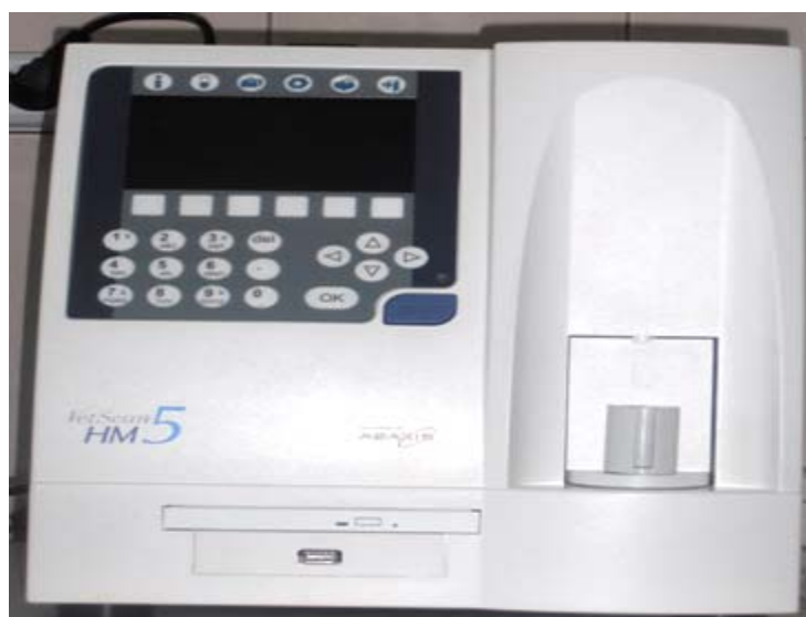
Рисунок 10 – Гематологический автоматический ветеринарный анализатор «Vetscan» для исследования крови
