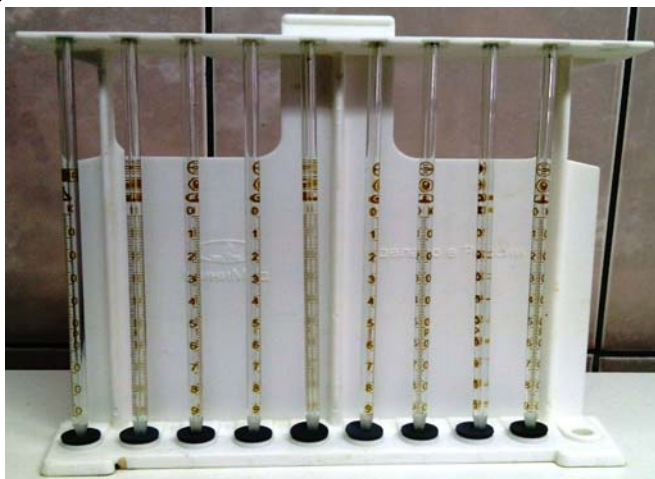
Рисунок 7 – Аппарат Панченкова для измерения СОЭ
