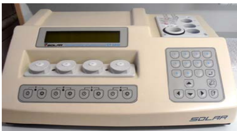
Рисунок 19 – Гемокоагулометр четырехканальный СТ 2410
